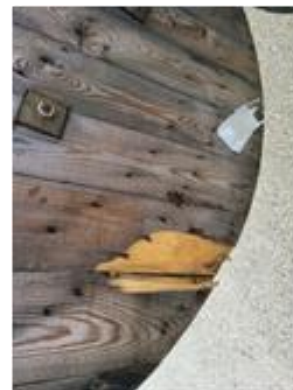
Trumgaveln med endast en enkel skada klassas 100%
