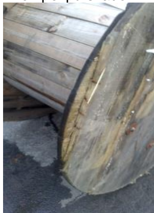
En kantbit borta. Trumman klassas som 80% om K11 eller större annars som 60%
