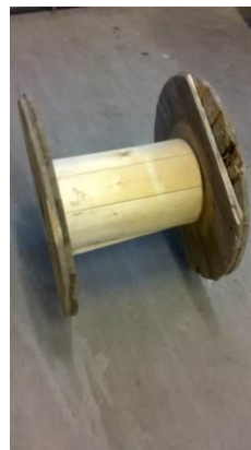
Trumgaveln bräckt då bägge lagren i gaveln är knäckta. Trumman
